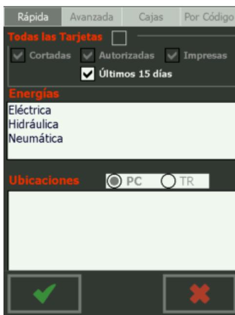
Los filtros se aplican en conjunto. En el caso de la captura, los Puntos de Corte de las tarjetas tienen que pertenecer a una de las ubicaciones técnicas y además ser de una de las energías listadas.
