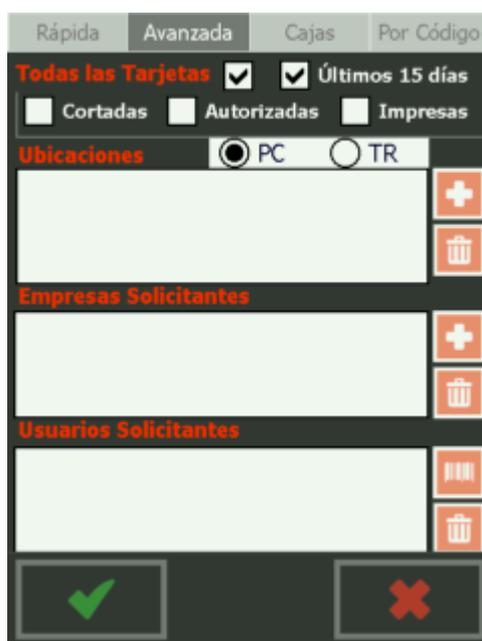
Según las casillas de verificación marcadas en la parte superior se podrán descargar todas las tarjetas (cumpliendo los filtros que hay más abajo), las tarjetas cortadas, las autorizadas o las impresas. Si no se marcan todas las tarjetas, el resto de casillas de verificación se pueden combinar entre sí.
